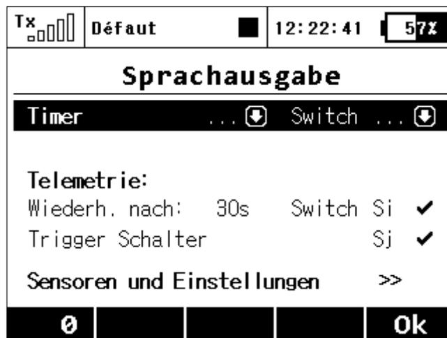
Sie können die Priorität der Variablen selbst setzen. Dadurch ändert sich auch die Reihenfolge der angesagten Werte.
