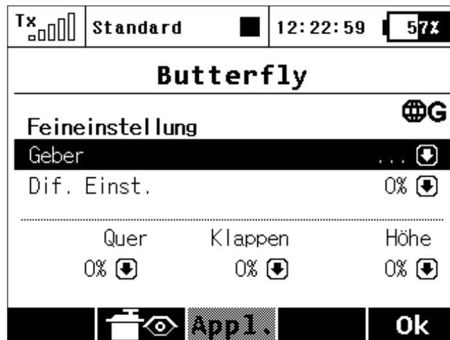
Die im Display angezeigte Schaltfläche **F(3)** „Apply“ arbeitet ähnlich das Querruder Differenzierungsmenue. Wenn Sie diese Taste drücken, werden die Werte im Butterfly-Einstellungsmenü in die entsprechenden Wege/Werte kopiert.
