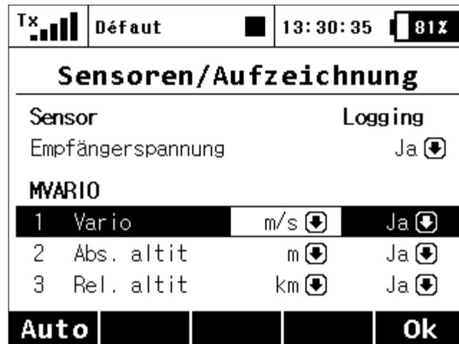
5. Eine automatische Erfassung von Daten des Wstech LinkVario wurde hinzugefügt. Der Ton der Steigsignalisierung des Varios wurde etwas geändert. Wenn das Vario so eingestellt ist, dass es bereits Steigen signalisiert wenn das Eigensinken unterschritten wurde, ist der Steigenton oberhalb 0m/s Steigen kürzer und die Pause länger.
