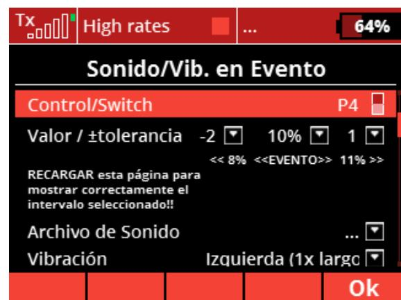
El Control/Switch puede ser de cada tipo de entrada ofrecida por la transmisora (por ejemplo: control, función, canal, etc.)
