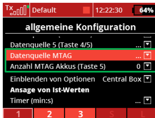
Abbildung 4: Verwendung eines MTAG Sensors. Der MTAG Sensor nutzt RFID Technologie um charakteristische Daten des verwendeten Akkus als Telemetriewert zu liefern.
