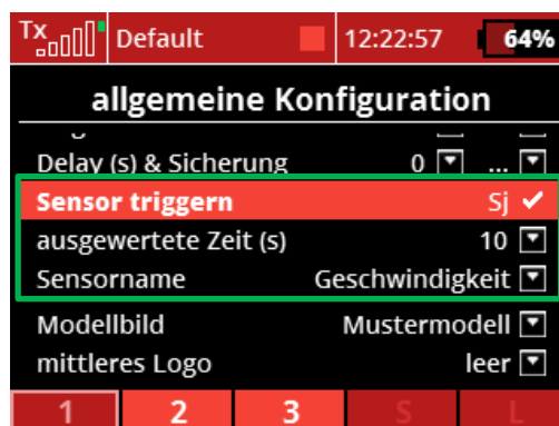
Abbildung 20: Funktion Sensor triggern. Die Funktion überwacht einen Telemetriewert über einen definierten Zeitraum und gibt das Maximum innerhalb des Zeitraums zurück.
