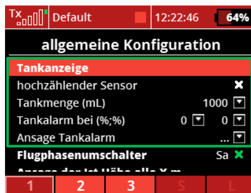
Abbildung 8: Tankanzeige. Diese Optionengruppe erlaubt die Hinterlegung von Informationen und Funktionen rund um den Treibstofftank.
