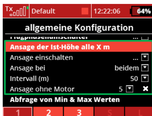
Abbildung 11: Ansage der Ist-Höhe alle X m. Diese Funktion ermöglicht automatisierte Höhenansagen abhängig von der erfassten Höhenänderung und dient vorrangig der Unterstützung beim Thermikfliegen
