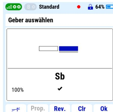
Abbildung 28: Definition eines 2-Stufen-Schalter
