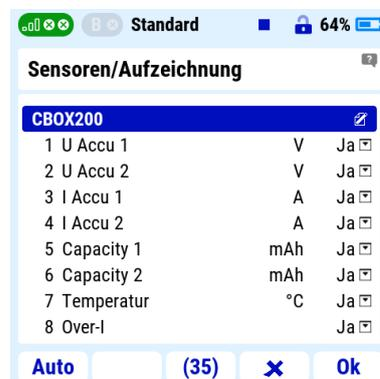
Abbildung 10: Von der Central Box 200 gelieferte Telemetriewerte
