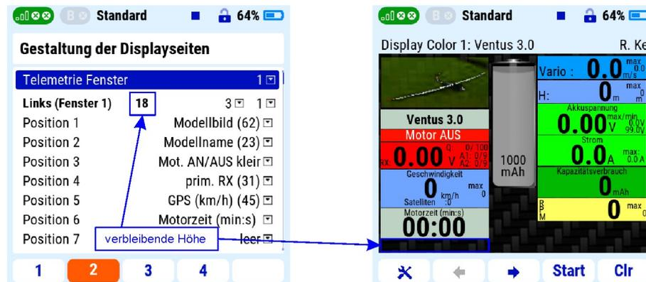
**Abbildung 1: Exemplarische Displayseite mit den Standardwerten der Rand und Kachelabständen.**
