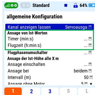
Abbildung 33: Funktionsblock *Anzeige von Ist-Werten*
