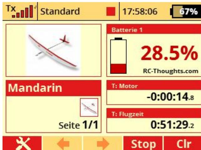
So sieht die Anzeige bei erreichtem Spannungslimit aus: Akku wird rot und Spannung wird mit zwei Nachkommastellen ausgegeben und wechselt im 2 Sekundentakt mit der Kapazitätsanzeige. Ist das Kapazitätslimit noch nicht erreicht bleibt die Schrift schwarz und nur die Spannung wird rot angezeigt. Der angezeigte Spannungswert entspricht der am niedrigsten gemessenen Spannung.
