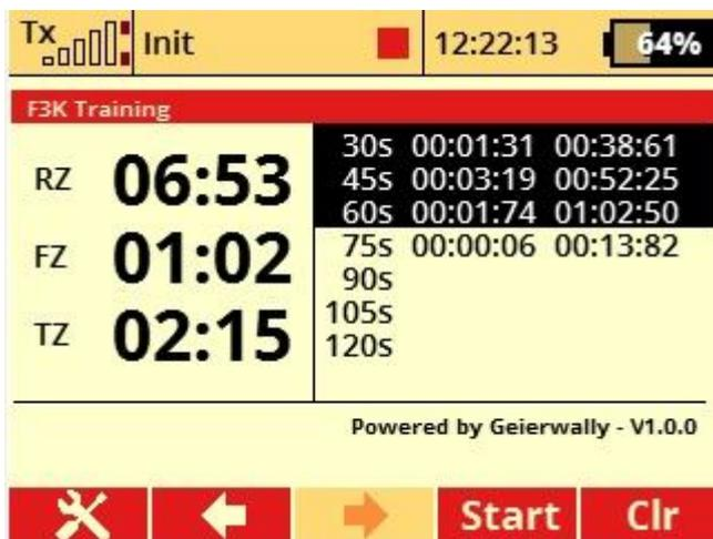
Für die App ist ein Telemetriefenster verfügbar. Die Timeranzeige hier entspricht der App Anzeige. Steuerung ist hier nur über die konfigurierten Schalter möglich (Key – Funktionen wie im App – Fenster entfallen). Nach Trainingsende werden über Kombischalter [Speichern](#) und [Reset](#) die Ergebnisse im File gespeichert und alle Zähler zurückgesetzt. Start eines neuen Trainings erfolgt über Schalter [Start Rahmenzeit](#).
