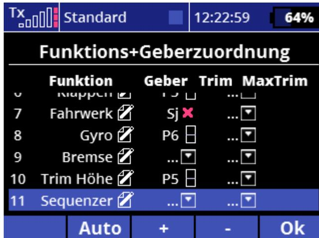
Servoausgang erstellen, zur Kontrolle der Funktion auf dem Servomonitor.
