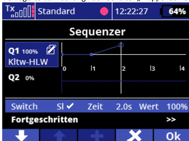
Ausschalten der Zumischung nach Schalter „Klapptriebwerk einfahren“
