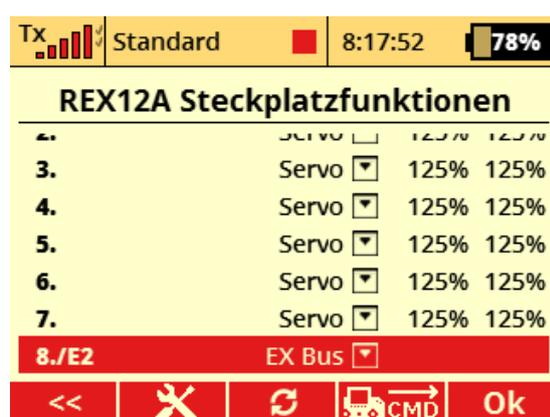
Nun wird der RSAT2 auf „EX Bus“ umgestellt. In der Geräteübersicht den RSAT anklicken und bei „serieller Ausgang“ auf „EX Bus & PPM pos“ wählen:
