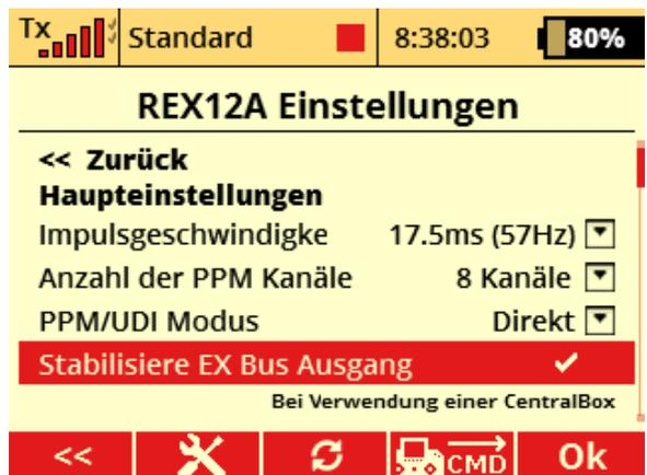
Zusätzlich das Failsafe des stabilisierten EX Bus deaktivieren. Im Failsafefalle des REX Assist gibt dieser nun kein Signal mehr aus und die CB200 kann auf den RSAT2 umschalten:
