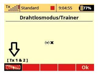
Möchte man die im Empfänger oder eine Central Box gesetzten Failsafe Einstellungen testen (z.B. "Motor aus" usw…), dann kann man auf die gleiche Weise auch alle Sendemodule ausschalten.
