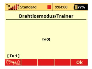
Funktionieren alle Steuerfunktionen, dann wieder die Taste mit dem Antennsymbol betätigen und den Test mit Tx-Modul 1 beenden. Jetzt zum zweiten, sekundären Tx-Modul wechseln.
