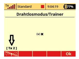
Nutzt man einen JETI Duplex Sender DC-24 oder DS-24 mit aktiviertem 900 Mhz Backup-System, testet man nun die Abschaltung beider 2,4Ghz Tx-Module und damit das 900Mhz Backup-System.
