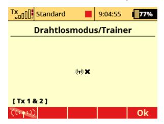
Sind alle Steuerfunktionen ok, diesen Test auch mit der "Antennen Taste" beenden.
