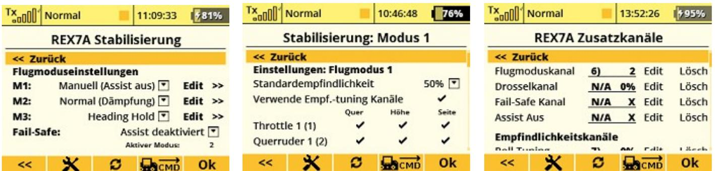
**Konfiguration/Kanalzuordnung** können Änderungen der **Haupt und Zusatzkanäle** vorgenommen werden, in Hauptkanäle kann eine Neukalibrierung erfolgen, was nach jeder Veränderung der Neutralstellung eines Ruders unbedingt vorgenommen werden soll. In Zusatzkanäle wird der der Schalter für die Umschaltung der Stabilisierung sowie Poti für die Empfindlichkeits-Einstellung programmiert. in der
