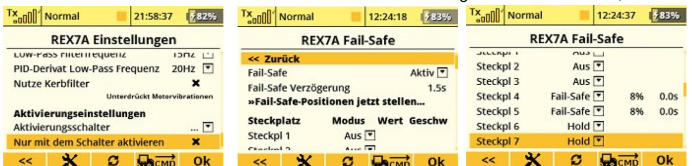
**Konfiguration/Fail-Safe** werden die Parameter festgelegt, welche bei Ausfall der Funkverbindung angewandt werden. Das Fail-Safe benötigt ebenfalls einen Kanal (beim 7-CH-Empf. Nur möglich
