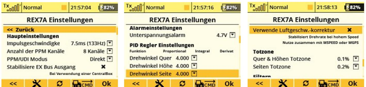
**Konfiguration/Erweiterte Einstellungen** können können alle Parameter eingestellt werden, welche einen Einfluss auf die Art und die Qualität der Stabilisierung einen Einfluss haben, im Menü
