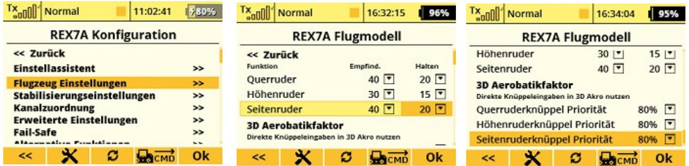
dass die Stabi-Wirkung an den Endstellungen um 80% reduziert wird. Im Menü **Konfiguration/Stabilisierungseinstellungen** können die Standardempfindlichkeit für alle Kanäle, sowie die Einwirkung auf die einzelnen Servoausgänge gesetzt werden. Die „Haken“ auf „Nicht-Ruder-Kanälen“ haben keinen Einfluss. Falls in einem Mode z.B. das Seitenrunder nicht stabilisiert werden soll, kann das in diesem Menü eingestellt werden. In Menü
